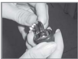
4 estrarre il gommino blu dal filtro e pulirlo, oppure sostituirlo con uno nuovo se necessario.
