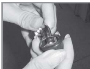
4 testare il gommino blu dal filtro e pulirlo, oppure sostituirlo con uno nuovo se necessario.
